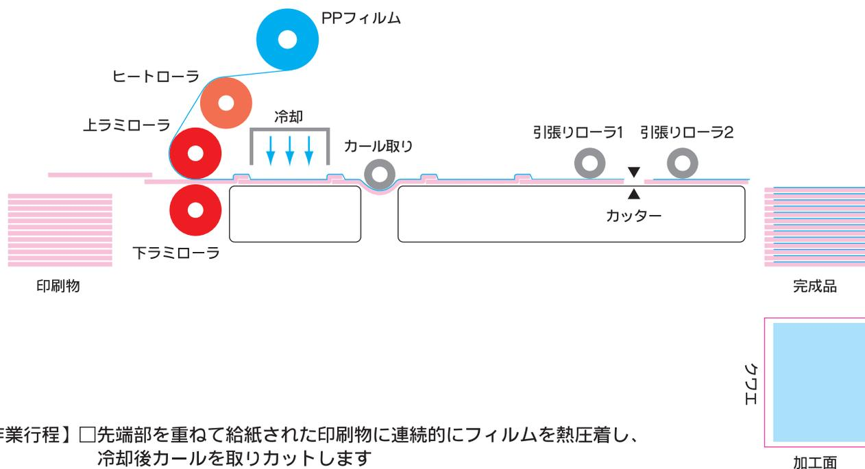
【作業行程】 □先端部を重ねて給紙された印刷物に連続的にフィルムを熱圧着し、冷却後カールを取りカットします
